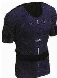
**P**rovate a pensare: elettrocardiogramma, holter (cioè un Ecg nelle 24 ore) e polisonnografia eseguiti tutti insieme, senza elettrodi né cavi. Come? Indossando il dispositivo, nella foto, che verrà fatta provare durante l'evento «Il cervello e il cuore si parlano?», Milano Heart Week, 28 Settembre, ore 19.30 al Museo della Scienza e della Tecnologia di Milano. È una maglietta hi-tech che permette di ottenere un monitoraggio ambulatoriale sofisticato, con
